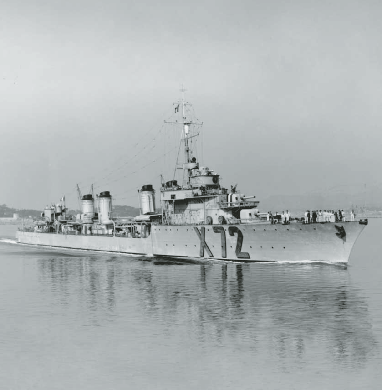
Le Gerfaut sortant de Toulon le 8 octobre 1941. Il a été partiellement transformé en août 1941 avec l'embarquement d'un 37 mm CAD mle 33 et le débarquement du mât arrière. (Marius Bar)
