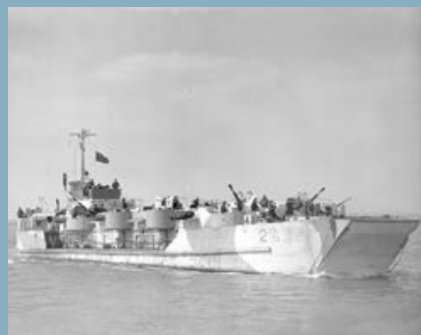
Le LCF 32 (Landing Craft Flak, ex LCT 623) fin avril 1944 lors d'un exercice près de l'île de Wight. L'armement comporte quatre canons de 2 pdr (40 mm) et huit de 20 mm. (IWM)
