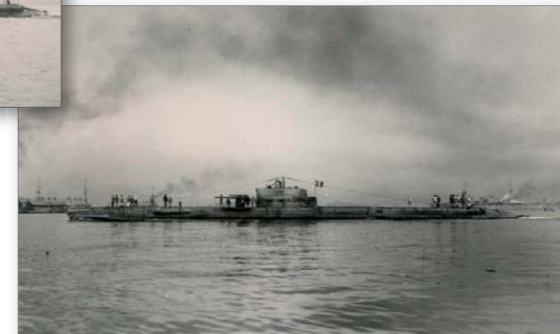
LA DORIS AUX ESSAIS À TOULON EN 1928. ON NOTERA LA SILHOUETTE D'ORIGINE DU KIOSQUE ET LE CANON DE 100 MM. (MARIUS BAR)
