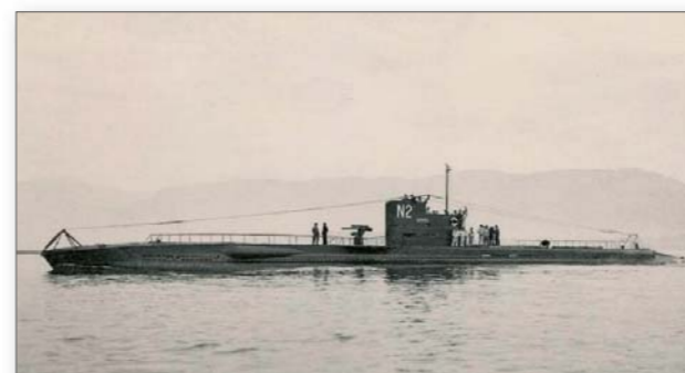
VERS 1933: SYMBOLE N2 NOUVEAU KIOSQUE, LE BLEU SOMBRE NOUVELLE COULEUR DE COQUE, LE MÂT DES SIGNAUX EST HISSÉ. (MARIUS BAR)
